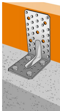
Bevestiging hout op harde beton
