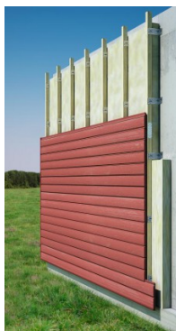
Mise en place d'un pare-pluie
