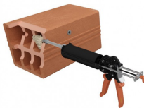
4. Vullen vanaf bodemgat naar buiten door bij het pompen telkens één maatstrep op de spuitmond achteruit te gaan.
