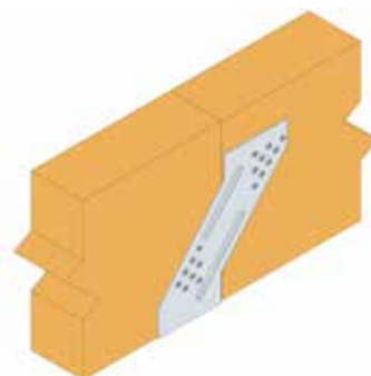
Vrijdragende SCR -ophangbeugel geïnstalleerd met CSA
