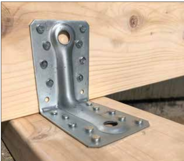
Verstevigd hoekijzer ABR9020 geïnstalleerd met CNA4.0X50 -nagels voor verbinders
