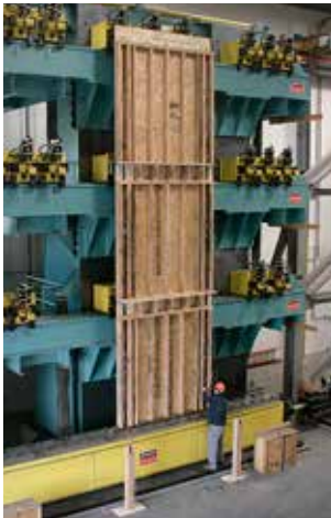
Test van een gebouw van drie verdiepingen op schaal 1. Laboratorium Simpson Strong-Tie - T.GILB Stockton
