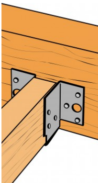
Fixation de pannes sur support bois
